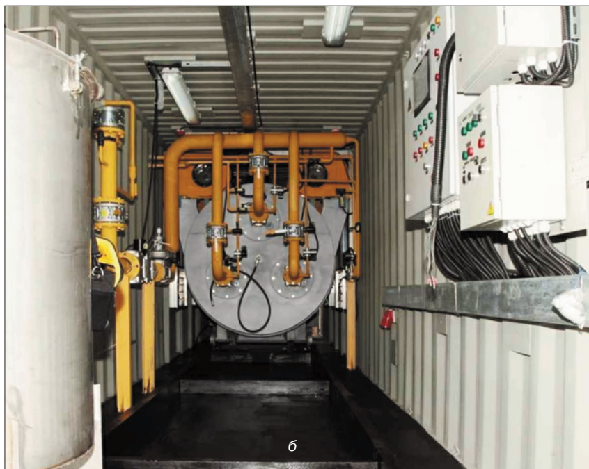
Рис. 1. Установка для уничтожения жидких отходов (шлам, сточные воды, буровые растворы) производительностью 300 м 3 /ч по ПНГ, 100 кг/ч по отходам (а) и циклонная топка (б) для утилизации ПНГ (1500 м 3 /ч)
