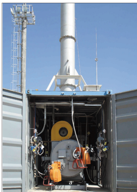
Рис. 1. Установка для уничтожения жидких отходов (шлам, сточные воды, буровые растворы) производительностью 300 м 3 /ч по ПНГ, 100 кг/ч по отходам (а) и циклонная топка (б) для утилизации ПНГ (1500 м 3 /ч)
